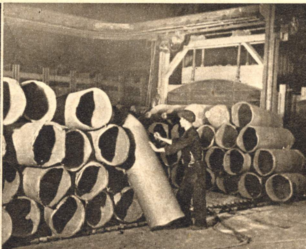
8 Danach nimmt ihn ein großes Lager auf, wo er in hohen luftigen Hallen vollends abkühlt. Sorgsam gestapelt, wartet er hier auf die Weiterverarbeitung
