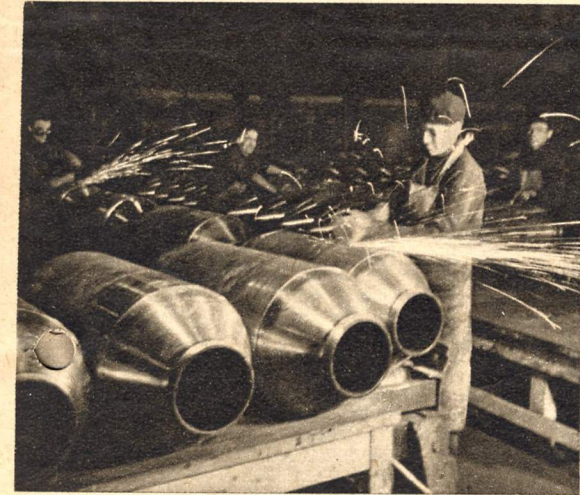
19 Die Außenhaut einer Bombe darf keine Unebenheiten zeigen, daher werden die Schweißstellen aufs sorgfältigste verschliffen und geglättet
